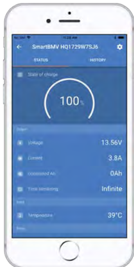
Puede ver más capturas de pantalla en la hoja informativa de la app VictronConnect BMV
